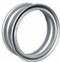
R 22.5. Угол конуса 28°. Вес 35/37 кг, нагрузка на колесо 3750/4000 кг (в зависимости от размерности колеса). Применение: КАМАЗ, МАЗ.
