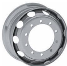
R 17.5-22.5. Толщина диска от 8 до 16 мм, вес от 19,6 до 46,5 кг (в зависимости от размерности). Применение: ISUZU, КАМАЗ, МАЗ, ПАЗ, IVECO, MAN и др.
