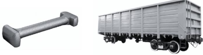
Вес 1,5 кг. Используется для подвешивания автосцепки СА-3 к грузовому вагону.
